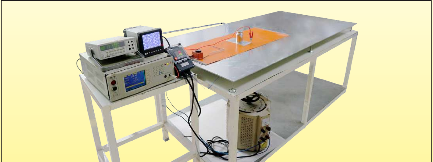
Apparecchiatura di misurazione per la dispersione di corrente totale a caldo
